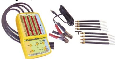
VacuumMate zeigt den individuellen Krümmerdruck von 4 separaten Vergasern (oder Kraftstoffeinspritzdrosselklappengehäusen) auf vier vertikal angeordneten hellen LED-Balken (40 LEDs je Balken), die auch bei Sonnenlicht sichtbar sind, sodass sich das Gerät für den Einsatz auf Booten und im Freien anbietet.
