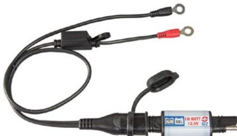
**0-123** : Für alle 12V-Batterien. Helle LEDs blinken, um eine GERINGE BATTERIELADUNG anzuzeigen, bei 50% verbleibender Ladung (12,5 Volt oder niedriger), für normale 12V-Batterien.
