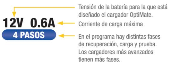
Algunos cargadores Optimate están diseñados para cargar dos tensiones de batería diferentes. Se mostrarán las dos potencias.
